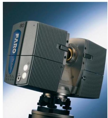
Figure 2 : Photographie de lidar terrestre
