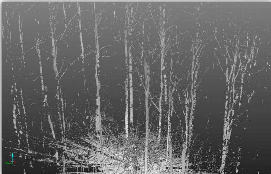
FIGURE 2 : VUE 3D D'UN NUAGE DE POINTS REPRESENTANT UNE SCENE FORESTIERE SCANNEE DEPUIS SON CENTRE, LOGICIEL FAROSCENE®.
